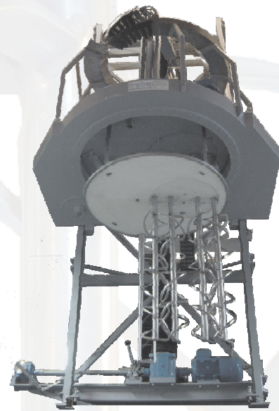
Konditionierungsanlage in China 1m 3 Fass
