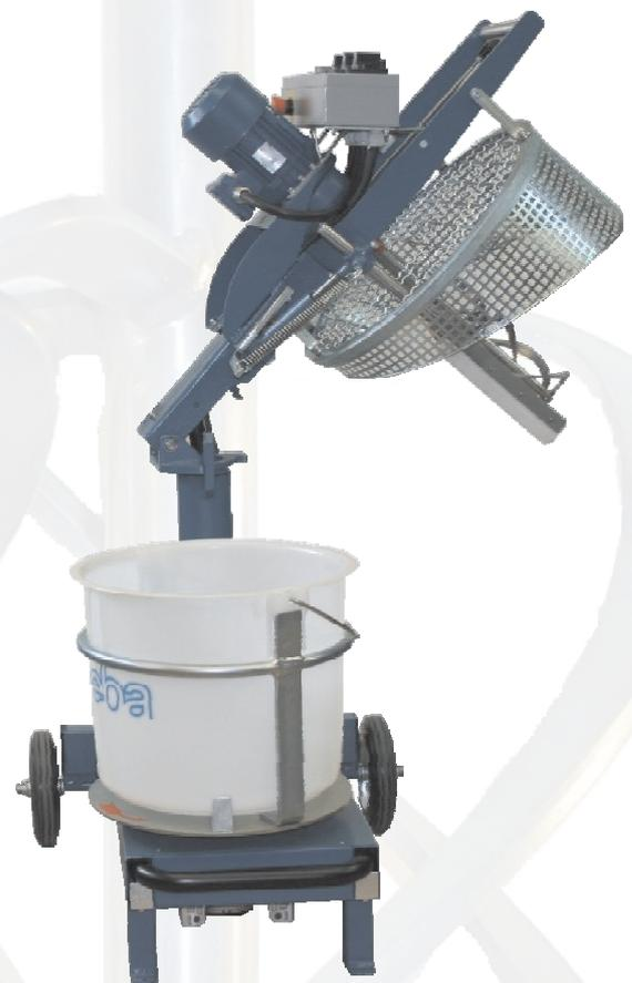
Ein Abstreifer schmiegt sich während des Mischprozesses an die Behälterwand zur Vermeidung ungemischter Randzonen. Die Federlagerung sorgt für eine schonende Behandlung des Mischbehälters. Die Rührwerkzeuge sind mit Schnellkupplungen ausgestattet, die ein rasches Auswechseln der Mischwerkzeuge ermöglichen.
